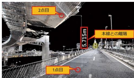
点群データによる2地点間の寸法計測状況
